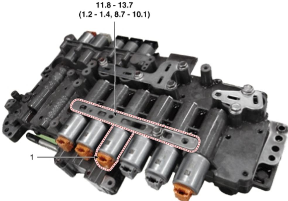
Tightening torque: N·m (kgf·m, lb·ft)
